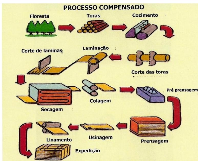
Figura 5 – Fluxograma do Processo Produtivo do Produto “Compensado”
