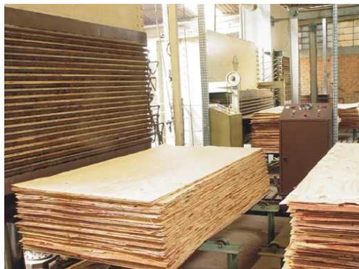
Figura 3 – Prensa Processo do “Compensado”
