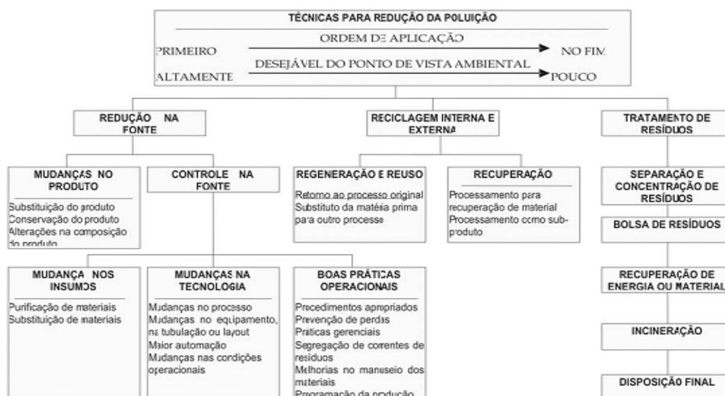
Fig. 3. Técnicas para Redução da Poluição (Fonte: Lagrega et al. (1994))
