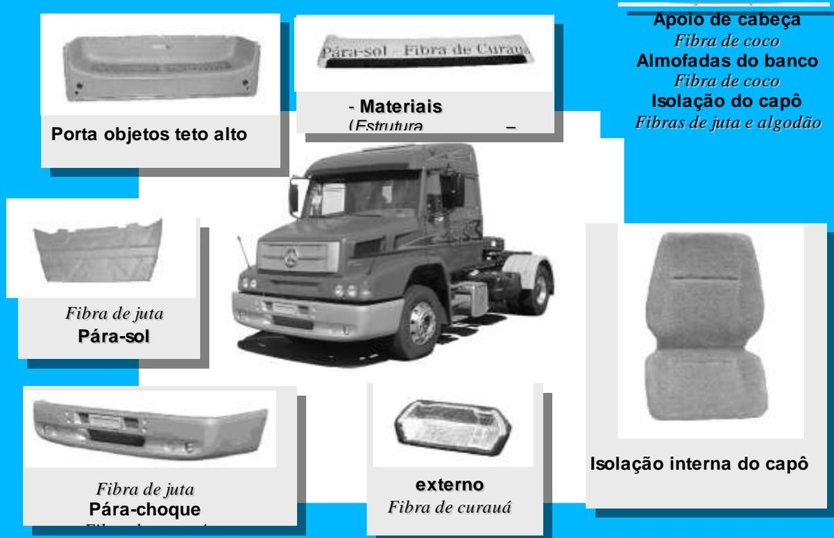
**Figura 1** - Componentes de um veículo comercial da DaimlerChrysler produzidos a partir de fibras naturais (Fonte: HEITZMANN, L.F. et al., 2001)
