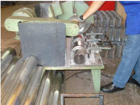
Figura 7. Processo de Corte dos tubos de Alumínio.
