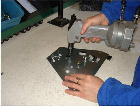
**Figura 2 - Pré - montagem das laterais dos duplicadores à álcool.**
