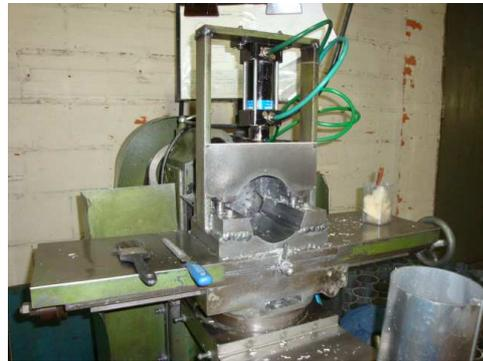
Figura 8. Processo de fabricação da fenda para inserção da régua no duplicador à álcool.
