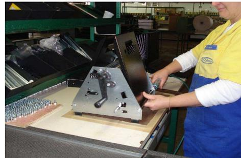
**Figura 4. Instalação das mesas suportes para alimentação e recebimento de papel.**
