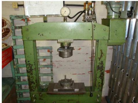
Figura 9. Prensa para fixação das laterais do cilindro.
