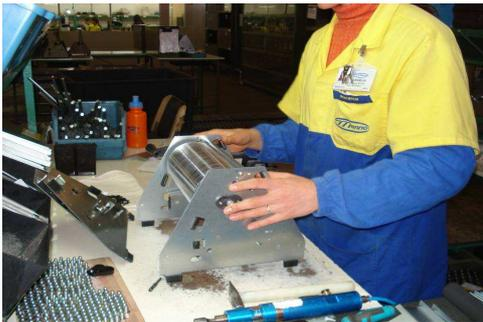
**Figura 3. Montagem do cilindro de alumínio com as laterais que estruturam o duplicador à álcool.**
